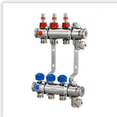
Techniprot, Rozdzielacze z rury nierdzewnej. Parametry techniczne: średnica 42,4x1,6; w gatunku 1.4301 (do instalacji c.o. i ogrzewania podłogowego).
