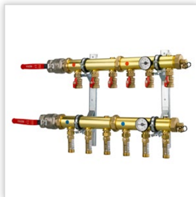
Techniprot, Rozdzielacze do pomp ciepła i innych instalacji grzewczych. Wykonanie: z rury mosiężnej w gatunku M 63, o średnicy 1¼", 1½" i 2.
