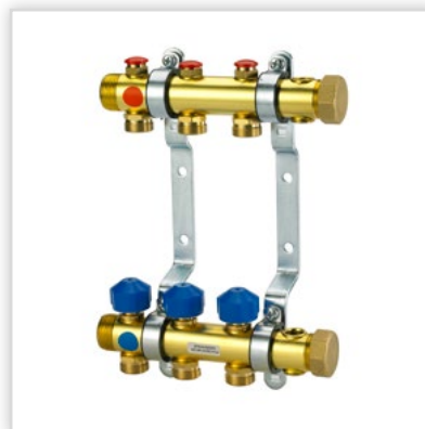
Techniprot, Rozdzielacze z rury mosiężnej. Parametry techniczne: średnica 33x2,5; w gatunku M 63 (do instalacji c.o. i ogrzewania podłogowego).
